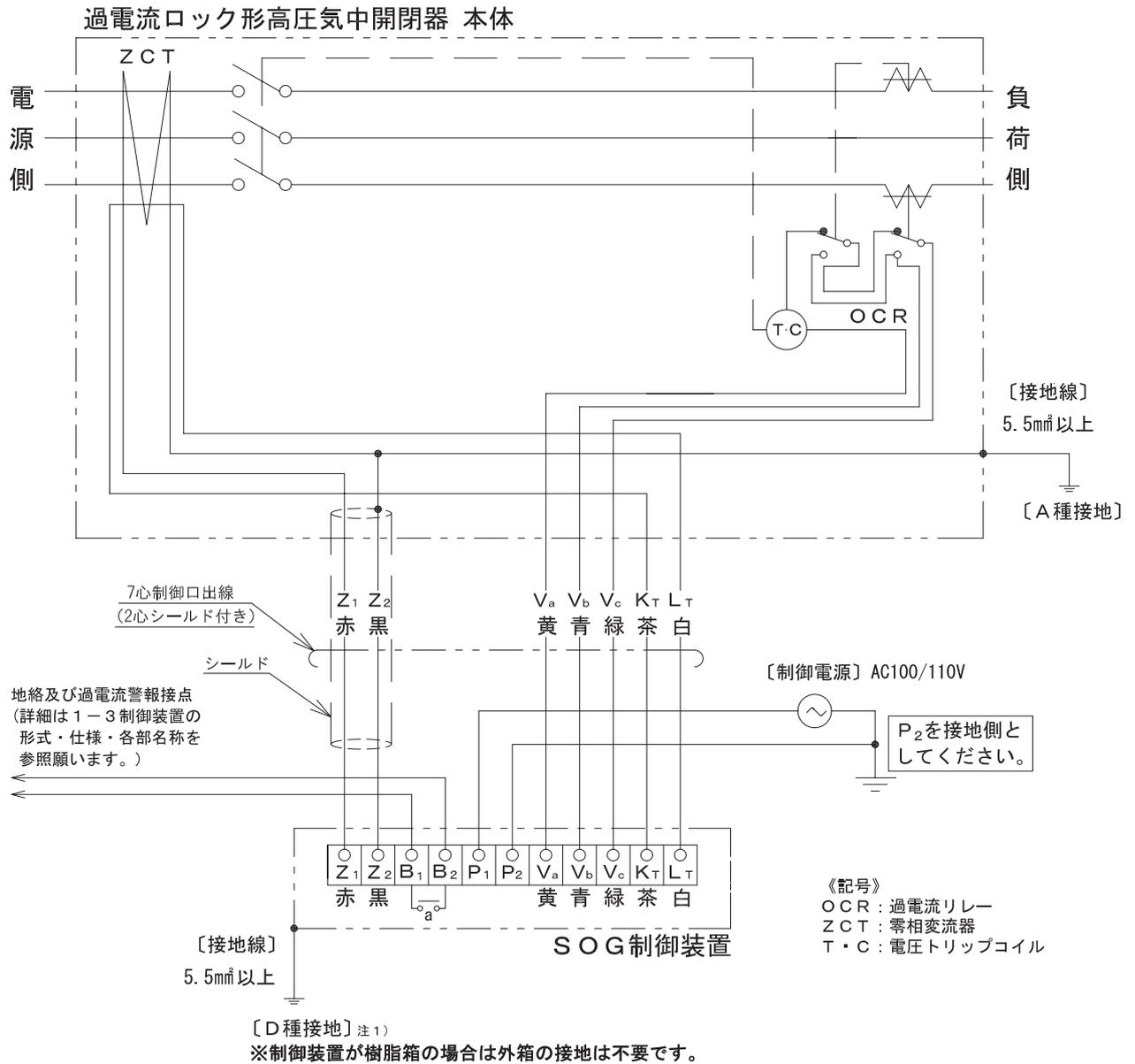
注1) 制御装置外箱の接地は開閉器A種接地と共用接地も可能です。詳細は(P19接地)を参照願います。
