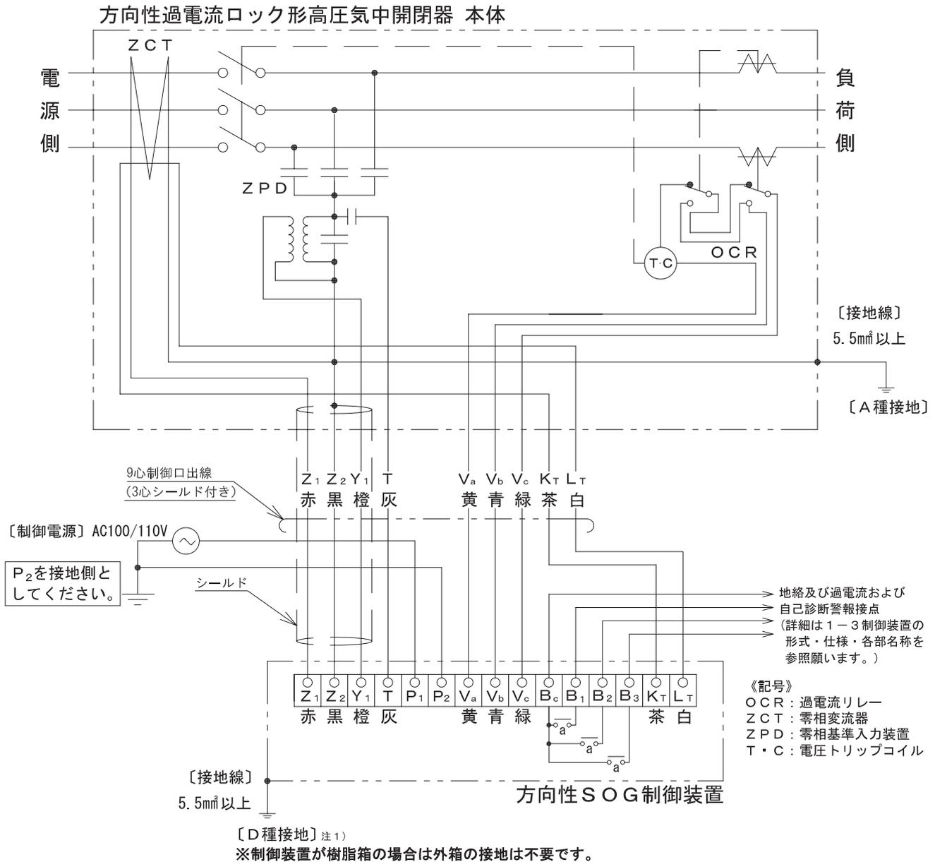
注1) 制御装置外箱の接地は開閉器A種接地と共用接地も可能です。詳細は (P19 接地) を参照願います。
