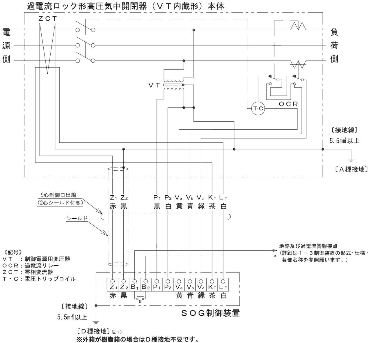
注1) 制御装置外箱の接地は開閉器本体A種接地と共用接地も可能です。詳細は P19 (接地) を参照願います。
