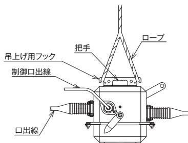
操作ハンドル・ブッシング・口出線・制御口出線を持って開閉器本体を引きずったり、持ち上げたりしないでください。機器の損傷（変形、気密不良、電線被覆のズレ等）の原因となります。
