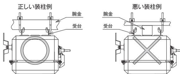
「悪い装柱例」のようなケース上板に直接荷重のかかる据付をしないでください。
