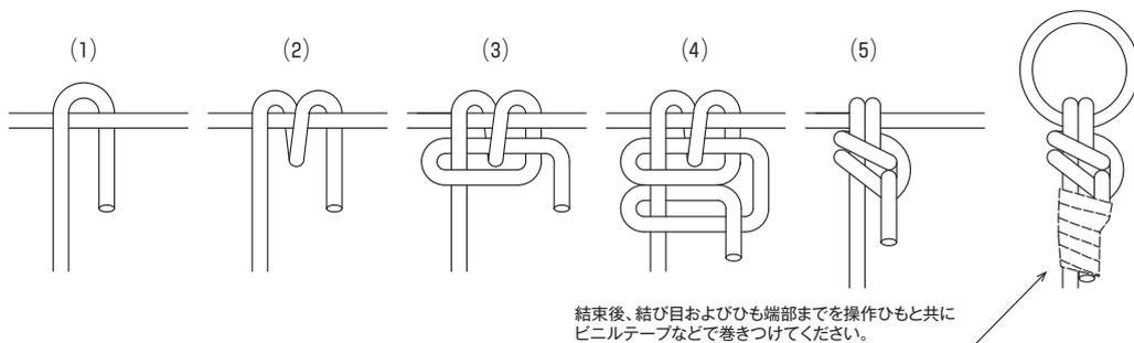
操作ひもにて開閉器の開閉操作を行い、操作ひもが外れないことを確認してください。
