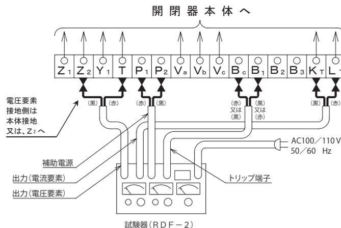
注1) 出力 (電圧要素) の接地側は、必ず本体接地 (又は Z<sub>2</sub>) と接続してください。接続を間違えた場合、正常なデータが得られない場合があります。
