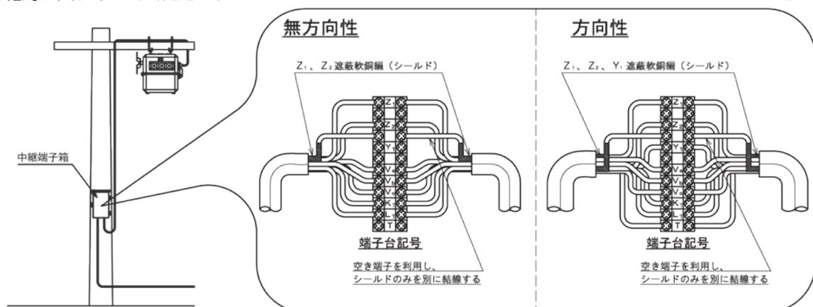
制御口出線のシールドと増設制御線のシールドを接続ください。
