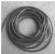
②エスロンロープ 被覆：ポリ塩化ビニル製 芯材：ガラス繊維製
