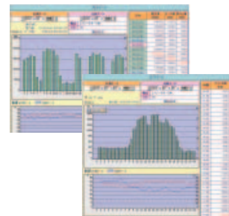
電力量・デマンド遠方監視システム(監視表示例)
