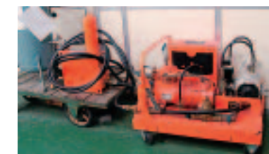
(SF 6 ガス回収装置)
